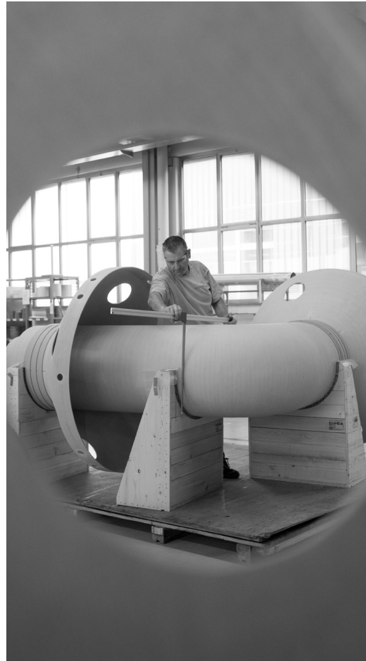
Produktion von zellulosebasierten Transformatorboards für Hochspannungstransformatoren (Bild:Matthias Jurt)
