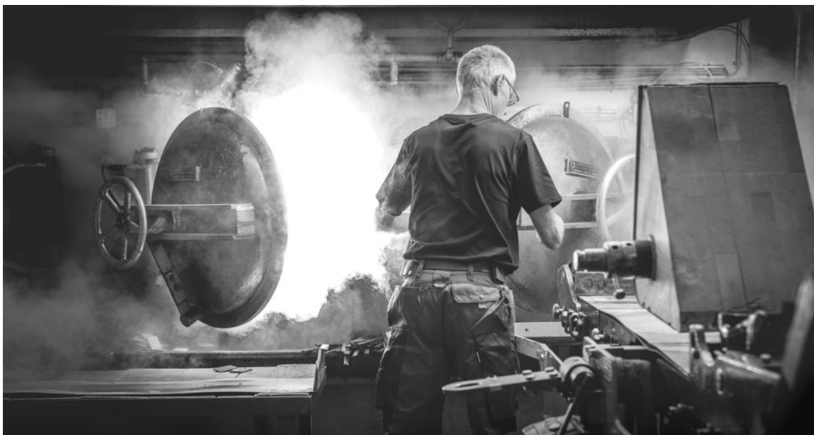
Das Holz wird im Wasserdampf für das Biegen vorbereitet. (Bild: K. Winkler AG)
