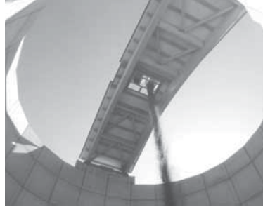
Befüllung eines Silos mit Hack-schnitzeln.
